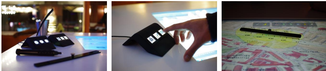
Figure 26. Solutions tangibles connectées à la table interactive d'INDIGO (stylo, règle, et boutons)
